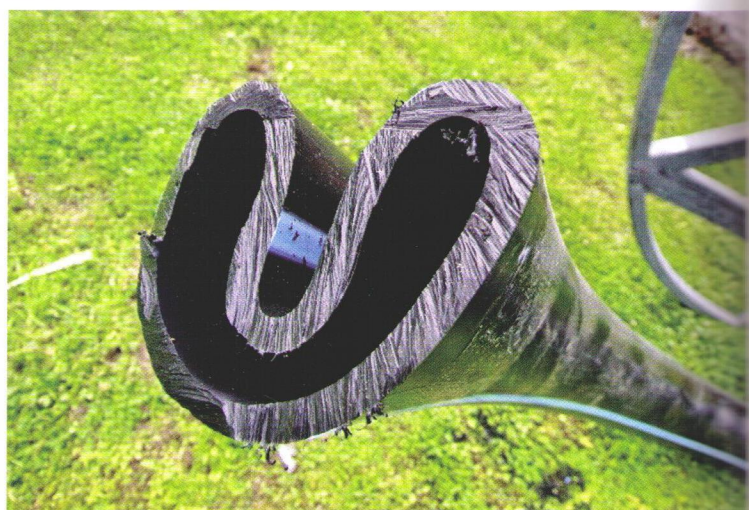
Bild 2: C-förmig gefaltetes extrudiertes Rohr bei der Close-Fit-Technik
