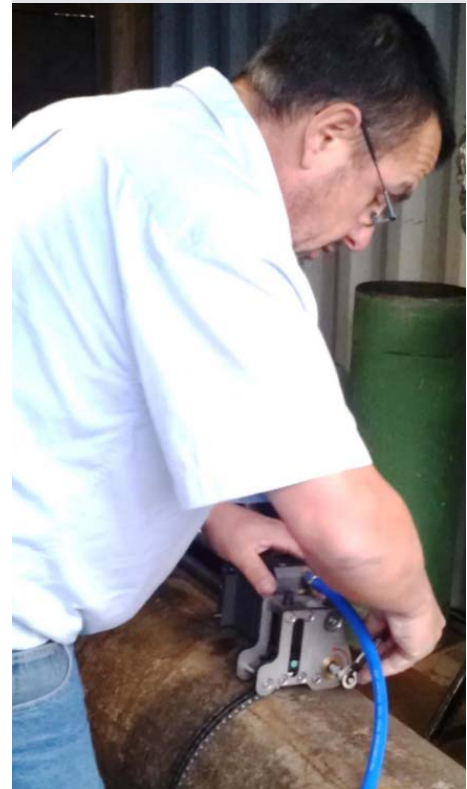
Der Window-Cutter wird auf dem Rohr angebracht. Mit dem Spezialgerät lassen sich präzise Öffnungen ausschneiden.
